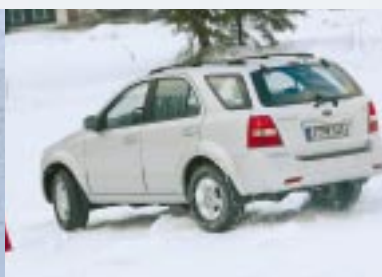
Kia Sorento Im tiefen Schnee flott unterwegs, sowohl auf der Kreisbahn als auch im Slalom, nervt die schwergängige Lenkung. Das ESP regelt in extremen Situationen brutal bis zum Stillstand, speziell dann, wenn der Sorento über die Vorderachse schiebt.
