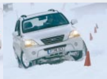
Kia Sorento Im tiefen Schnee flott unterwegs, sowohl auf der Kreisbahn als auch im Slalom, nervt die schwergängige Lenkung. Das ESP regelt in extremen Situationen brutal bis zum Stillstand, speziell dann, wenn der Sorento über die Vorderachse schiebt.
